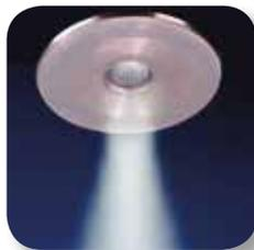
Die zentrale Lochblende hat einen Durchmesser von lediglich 5 mm und verfügt über 1000 präzisionsgeformte Löcher. Die Lochplatte vibriert 128.000 Mal pro Sekunde und erzeugt Aerosolpartikel, die für eine maximale Lungendeposition optimiert sind.
